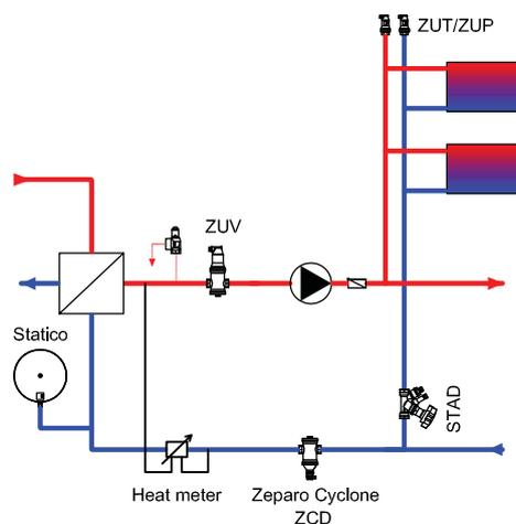
Сепаратор шлама Zeparo Cyclone устанавливается на обратном трубопроводе перед защищаемой установкой или перед источником энергии. Для установки Zeparo Cyclone не существует особых требований к расстоянию до или после него.
