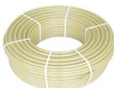
труба PE-Xc с антидиффузионной защитой соотв. DIN 4726 предназначена для системы ц. о. и подпольного отопления с рабочим давлением 6 бар
