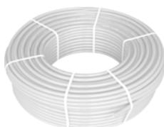
труба PE-RT с антидиффузионной защитой предназначена для системы ц. о. и подпольного отопления с рабочим давлением 6 бар
